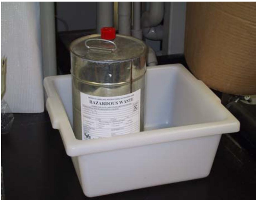
شکل ۸- محفظه ثانویه ظرف پسماند شیمیایی خطرناک
